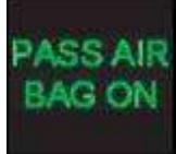
如果乘客侧安全气囊启用, TFT 显示屏显示相应的图标。
