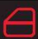
TFT 显示屏显示车辆，在代表车门、行李箱盖和发动机舱盖开启的区域以红色“高亮显示”，并显示特定信息 “**Door open**”(车门开启)、“**Doors open**”(多个车门开启)、“**Trunk open**”(行李箱盖开启)、“**Bonnet compartment open**”(发动机舱盖开启)或 “**Trunk and bonnet open**”(行李箱盖和发动机舱盖开启)。
