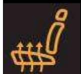
TFT 显示屏显示图标和特定信息 “**Front LH Seat Heater**”(左前座椅加热器) / “**Front RH Seat Heater**”(右前座椅加热器)。
