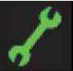
TFT 显示屏显示图标和特定信息 “**Service Stop within:**”(下次维修时间: ), 后面紧随到下次车辆维修期剩余的“公里数”(或“英里数”)或“天数”。
